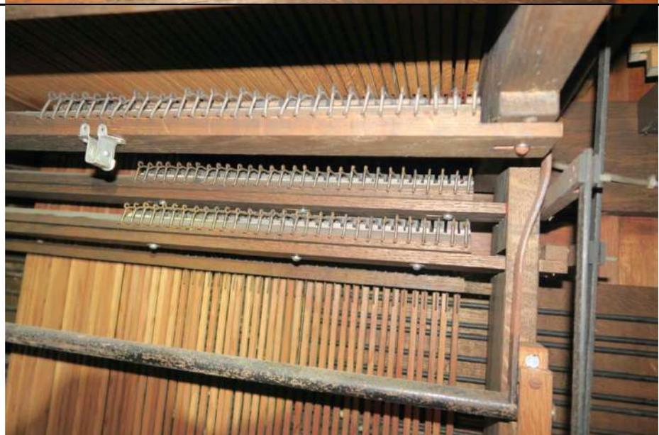
Le fonctionnement des balanciers du positif de dos est aléatoire et pour l'instant soulagé par des élastiques !
